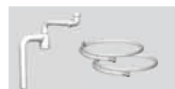
Slangpaket 1 st avloppsslang, längd 70,0 - 103,0 cm. Diameter vid anslutning 5,0 cm alternativt 4,0 cm (vid kopning). 2 st vattenslangar, längd 80,0 cm, anslutning R15 (1/2").
