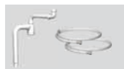
Slangpaket 1 st avloppsslang, längd 70,0 - 103,0 cm. Diameter vid anslutning 5,0 cm alternativt 4,0 cm (vid kopning). 2 st vattenslangar, längd 80,0 cm, anslutning R15 (1/2").
